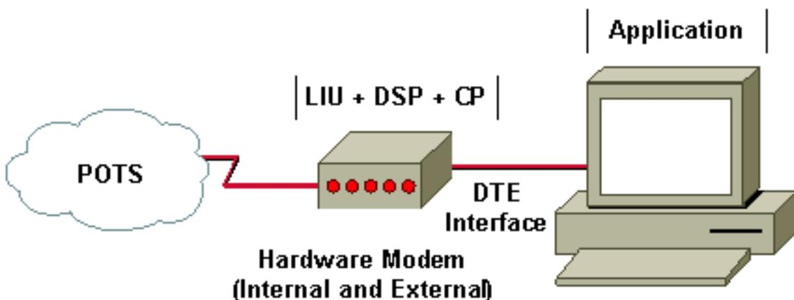
하드웨어 모뎀에서 모뎀은 LIU, DSP 및 CP 기능을 처리합니다. 하드웨어 모뎀은 지금까지 성능이 가장 우수하고 가장 안정적인 유형이었습니다. 하드웨어 모뎀은 외부 또는 내부일 수 있습니다. 외부 모뎀을 사용하면 물리적 케이블(예: RS-232 직렬 인터페이스)이 컴퓨터를 모뎀에 연결합니다. 내부 하드웨어 모뎀에서 컴퓨터의 내부 버스가 이 기능을 처리합니다.
