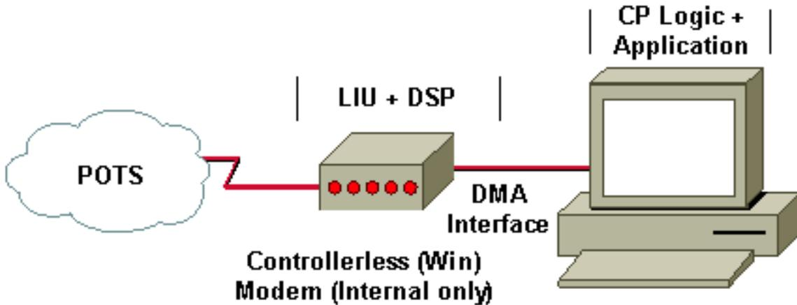
컨트롤러가 없는 모뎀에서 CP 로직은 컴퓨터 운영 체제로 이동하는 반면 LIU 및 DSP는 모뎀 하드웨어 자체에서 수행됩니다. 이 설계는 하드웨어 DSP가 실시간 변조 작업을 처리하는 반면, 컴퓨터는 CPU 또는 메모리 집약적인 데이터 압축 기능을 처리할 수 있기 때문에 적합합니다. 훌륭한 설계로 하드웨어와 컨트롤러가 없는 모뎀의 차이는 거의 눈에 띄지 않습니다. 이는 오류 수정 시 CPU 성능 손실과 데이터 압축이 DSP와 컴퓨터 간에 더 효율적으로(인터럽트 수 감소) 이동함으로써 보상되기 때문입니다.
