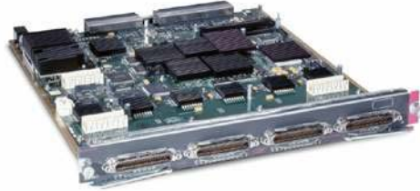
그림 4. Cisco Express Forwarding 256 코퍼 10/100 인터페이스 모듈(부품 번호 WS-X6548-RJ-21)
