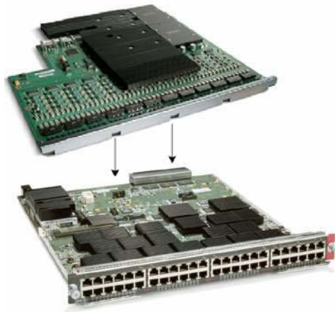
그림 6. Cisco 클래식 96 포트 10/100 802.3af PoE 모듈(부품 번호 WS-X6148X2-45AF)
