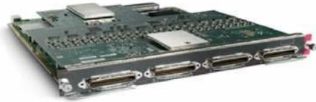
그림 9. (802.3af PoE 모듈 현장 업그레이드 옵션을 장착한) 시스코 클래식 96 포트 10/100(부품 번호 WS-X6196-RJ-21)
