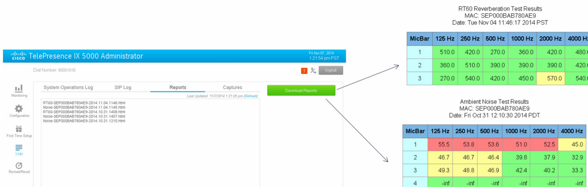
図 7 [レポート (Reports)] 画面と RT60 およびノイズレベル HTML ファイル例。
