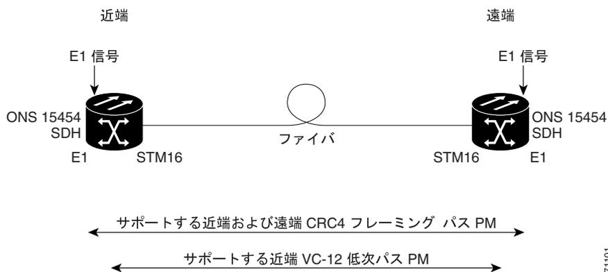
図5-2に、E1-N-14カードのApplication-Specific Integrated Circuit (ASIC; 特定用途向IC)上で検出されたオーバーヘッドバイトが、PMパラメータを生成する場所を示します。
