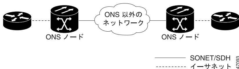
図 21-5 G シリーズカードの手動クロスコネク
