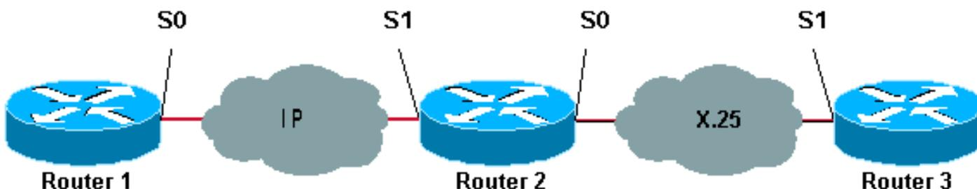
図に示すように、ルータ 1 と 2 の間およびルータ 2 および 3 の間でバックツーバック リンクが使用されます。
