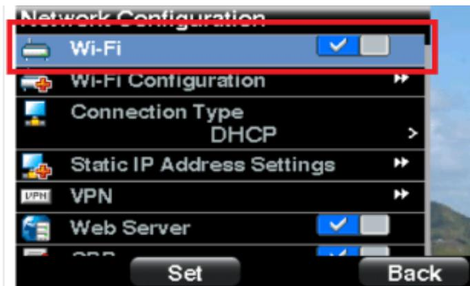
ステップ3d:電話機がイーサネットに接続されていないことを確認します。イーサネットへの接続中はWi-Fiを有効にできますが、インターネットにアクセスできません。
