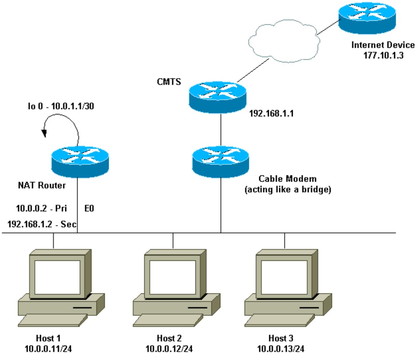
上のネットワーク ダイアグラムはケーブル モデムの設定におけるごく一般的なものです。Cable Modem Termination System ( CMTS; ケーブルモデム終端システム ) はルータであり、Cable Modem ( CM; ケーブル モデム ) はブリッジと同様に機能する装置です。ここで問題になるのは、インターネットにアクセスする必要があるホスト数に十分見合った有効なアドレスが Internet Service Provider ( ISP; インターネット サービス プロバイダー ) から与えられていないことです。ISP からはアドレス 192.168.1.2 が与えられていましたが、これは装置用として使用する必要がありました。さらに要求があると、192.168.2.1 ~ 192.168.2.3の3つのアドレスが受信され、NATは10.0.0.0/24の範囲のホストを変換します。
