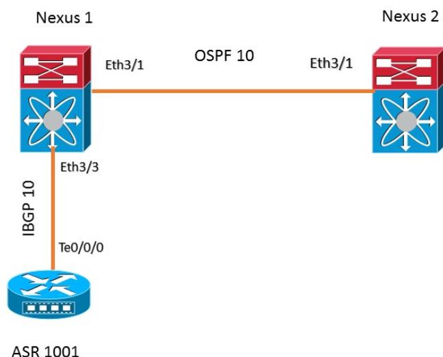
このトポロジ例では、OSPF の隣接性は 2 つの Nexus デバイスの間で設定されています。ASR1001 ルータには、Nexus 1 との iBGP ピアリングがあります。Nexus 1 は、Nexus 2 に送信するための OSPF プロセス 10 に再配布される iBGP を通して、ASR 1001 からプレフィックス 192.168.1.0/24 を学習します。
