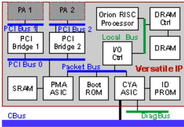
SAR では、パケットメモリへの伝送用に PCI バスへの接続を提供しています。また ATM のセル処理や、外部配線への PHY または物理インターフェイスに関する SAR 機能もあります。
