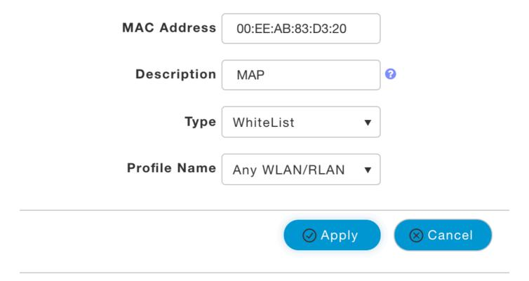
Une fois cette configuration effectuée, une liaison maillée doit être établie. Pour que le client filaire derrière le MAP puisse transmettre le trafic sur la liaison maillée, le pontage Ethernet doit être activé sur le MAP sous Wireless Settings > Access Points > MAP > Mesh:
