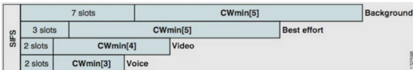
Avec WMM, les paquets dans les différentes files d'attente de classe d'accès sont hiérarchisés en fonction de différentes variables de réémission aléatoire.
