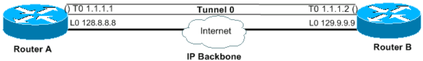
Figure 1 - Exemple de mécanisme de maintien du tunnel
