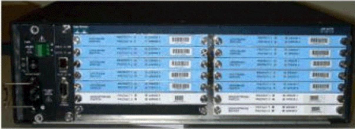
Dix modules US (en bleu) et trois modules DS (en gris) sont installés dans le commutateur RF 3x10. La partie inférieure gauche est appelée module N et est vide. Les modules situés à l'avant, à partir du coin supérieur droit, sont les numéros 1 à 13 et sont corrélés aux ports A-M. Le module 1 en amont comporte tous les relais du port A des logements 1 à 8 et protège 1 et 2 à l'arrière. Le module 2 se trouve à gauche et comporte tous les relais du port H dans les logements 1 à 8 et protège 1 et 2.
