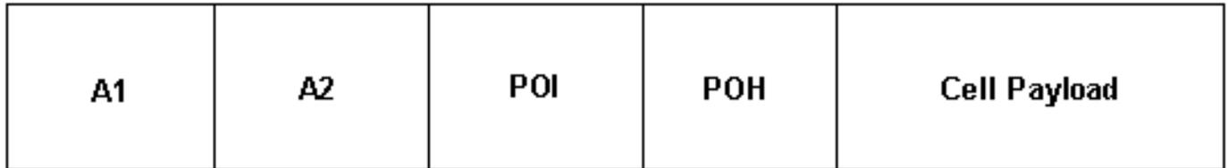
Dans ce schéma, le POI correspond à l'indicateur de surcharge de chemin et le POH à l'indicateur de surcharge de chemin. A1 et A2 assurent l'alignement des trames et doivent suivre un modèle distinct de 1 et de 0.
