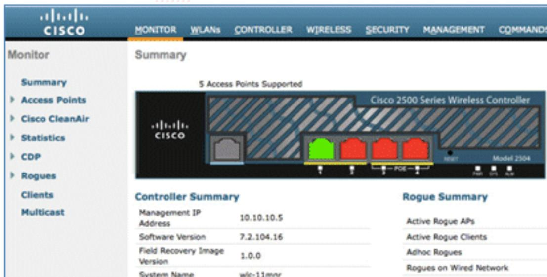
2. Navegue hasta **Seguridad > RADIUS > Autenticación**, y agregue el servidor RADIUS al WLC.
