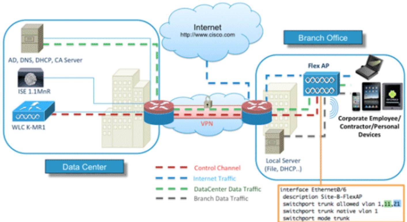
Para esta simulación, necesita una red con un AP FlexConnect, un sitio local/remoto con DHCP local, DNS, el WLC y el ISE. El AP de FlexConnect está conectado a un tronco para probar el switching local con varias VLAN.
