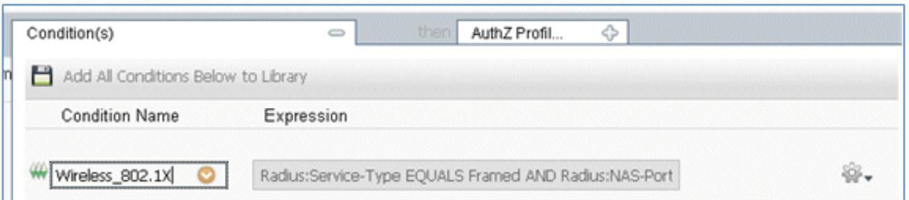
70. Haga clic en el icono de engranaje en el lado derecho de la condición y seleccione **Agregar atributo/valor**. Se trata de una condición 'and', no 'or'.
