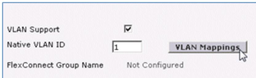
4. Establezca el ID de VLAN en 21 (en este ejemplo) para el SSID para la conmutación local.
