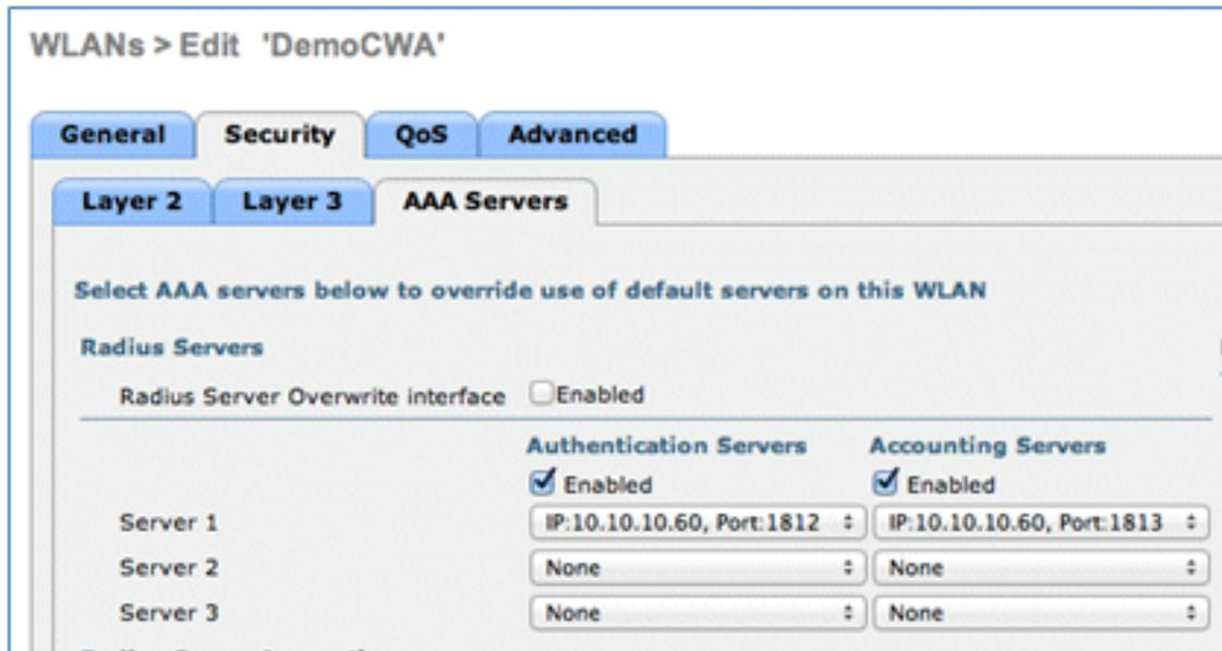
4. Desplácese hacia abajo desde la pestaña **AAA Servers**. En Orden de prioridad de autenticación para el usuario de autenticación web, asegúrese de que **RADIUS** se utiliza para la autenticación y de que no se utilizan los demás.
