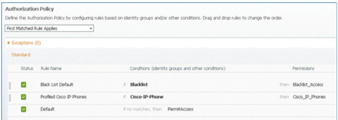
59. A la derecha de la segunda regla (Teléfonos IP de Cisco con perfil), haga clic en la flecha hacia abajo junto a Editar y seleccione **Insertar nueva regla debajo**.
