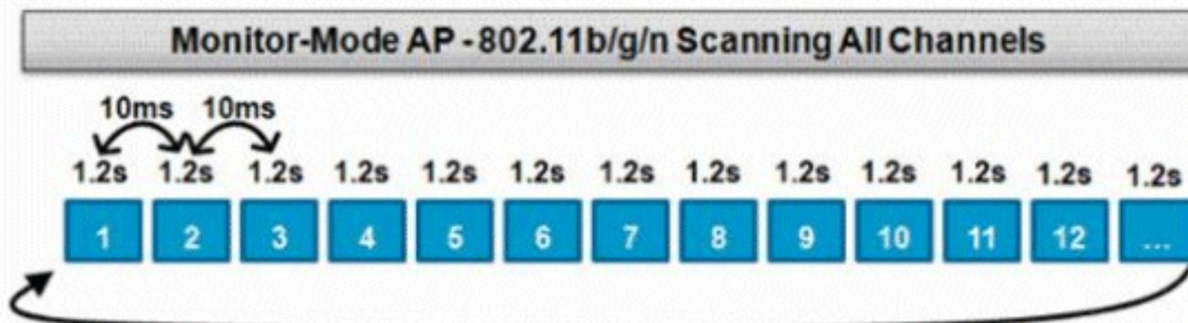
Este gráfico es una representación del algoritmo de escaneo fuera de canal para un AP en modo monitor en la banda de frecuencia de 2.4GHz. Una operación similar se realiza en paralelo en la radio de 5 GHz si el AP tiene uno presente.
