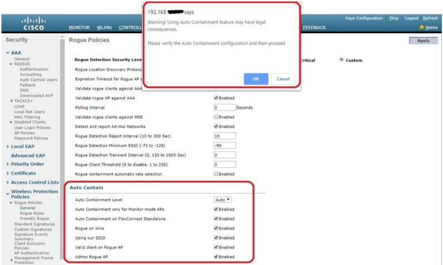
Haga clic en Aplicar para enviar los datos al WLC de Cisco, pero los datos no se conservan a través de un ciclo de energía; estos parámetros se almacenan temporalmente en la RAM volátil.
