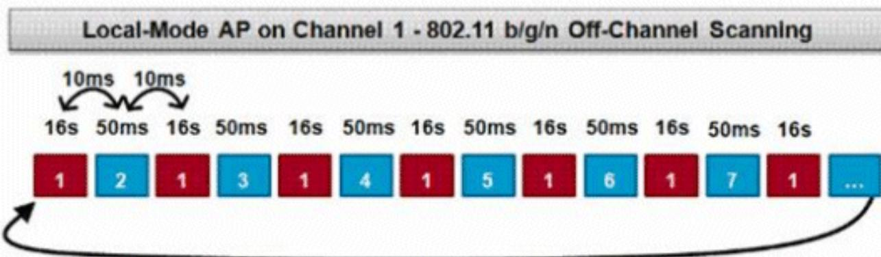
Este gráfico es una representación del algoritmo de escaneo fuera de canal para un AP de modo local en la banda de frecuencia de 2.4GHz. Una operación similar se realiza en paralelo en la radio de 5 GHz si el AP tiene uno presente. Cada cuadrado rojo representa el tiempo empleado en el canal de inicio de los AP, mientras que cada cuadrado azul representa el tiempo empleado en los canales adyacentes para fines de escaneo.
