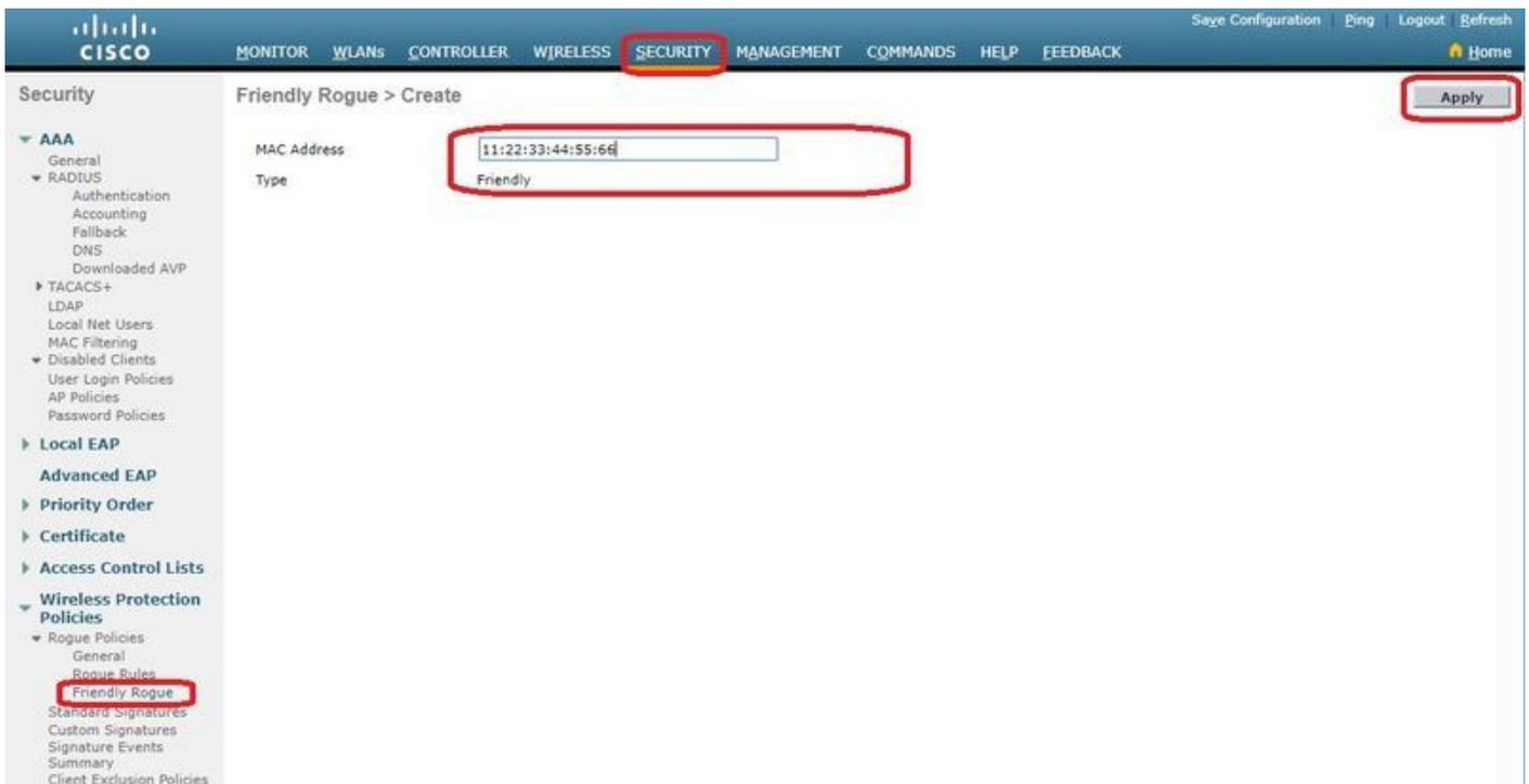
Configuración de un punto de acceso de detector no autorizado
