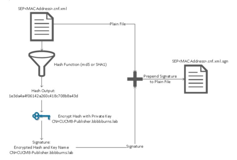
La verificación de la firma invierte este proceso mediante el uso de la clave pública que coincide
