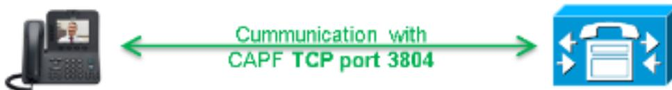
**Nota:** El teléfono inicia una sesión de seguridad de la capa de transporte (TLS) al servicio CAPF en el puerto 3804 de forma predeterminada.
