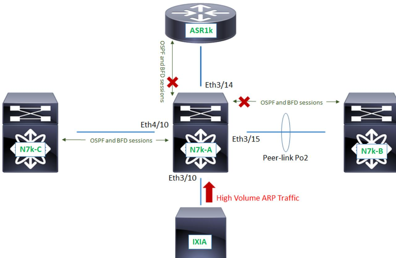
Los siguientes resultados confirman el impacto de una tormenta de paquetes ARP en las sesiones BFD y OSPF en el módulo en la ranura 3. A diferencia de esta sesión BFD y OSPF en el módulo en la ranura 4 se establecen y se mantienen estables.
