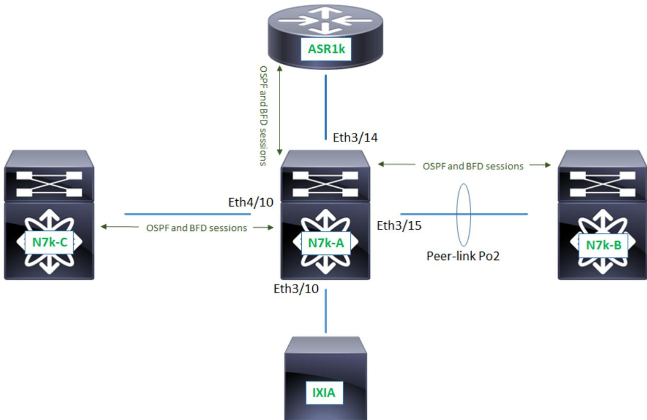
Aquí se utiliza N7k-A como dispositivo sometido a prueba (DUT). DUT es un switch Nexus 7009 con la siguiente configuración de hardware
