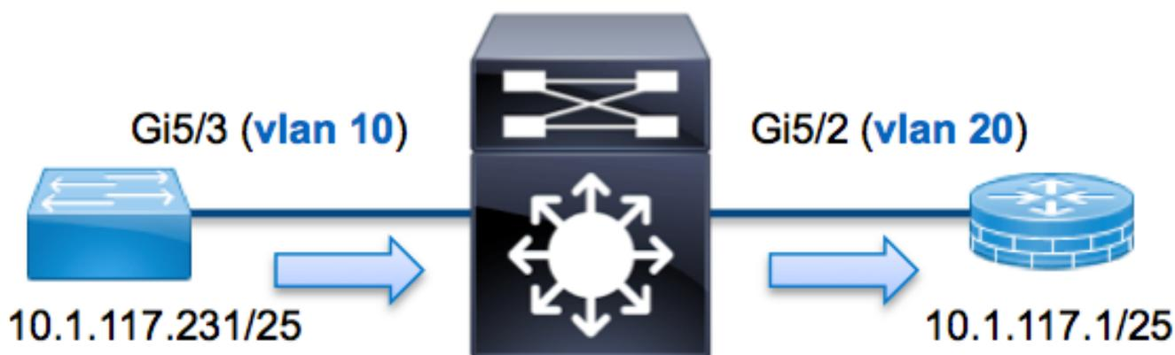
En este ejemplo, un host en VLAN 10 (10.1.117.231), el puerto G5/3 envía una solicitud de protocolo de mensajes de control de Internet (ICMP) a un host en VLAN 20 (10.1.117.1), puerto G5/2. ELAM se utiliza para capturar este paquete único de 10.1.117.231 a 10.1.117.1. Es importante recordar que ELAM le permite capturar una única trama.
