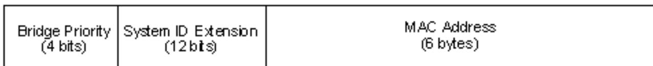
Cuando la función de reducción de direcciones MAC está habilitada en los switches Catalyst para aprovechar VLAN de rango extendido, habilite la reducción de direcciones MAC en todos los switches dentro del mismo dominio STP. Este paso es necesario para mantener la uniformidad de los cálculos de raíz STP en todos los switches. Después de que habilite la reducción de direcciones MAC, la prioridad de root bridge se convierte en un múltiplo de 4096 más el ID de
