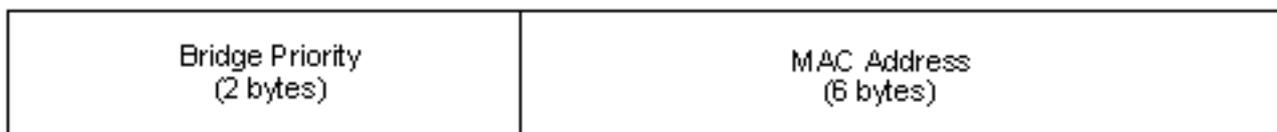
La reducción de direcciones MAC modifica la parte del identificador de bridge STP de la BPDU. El campo de prioridad original de 2 bytes se divide en dos campos. Esta división da lugar a un campo de prioridad de bridge de 4 bits y a una extensión del ID del sistema de 12 bits que permite la enumeración de VLAN de 0 a 4095.
