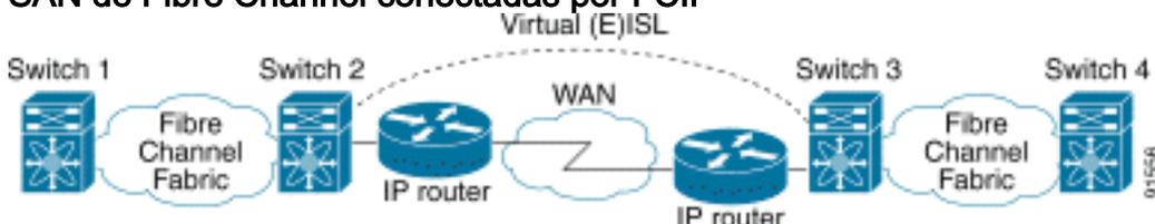
FCIP utiliza el protocolo de control de transmisión (TCP) en el puerto 3225 como transporte de capa de red.
