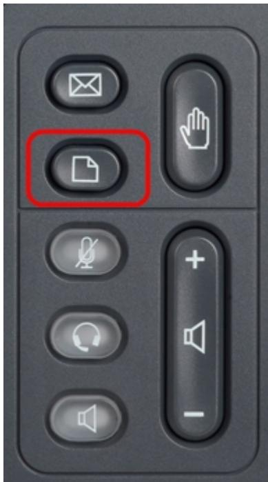
Paso 1. Presione el botón **Setup** del teléfono IP para que aparezca el *menú Setup*.
