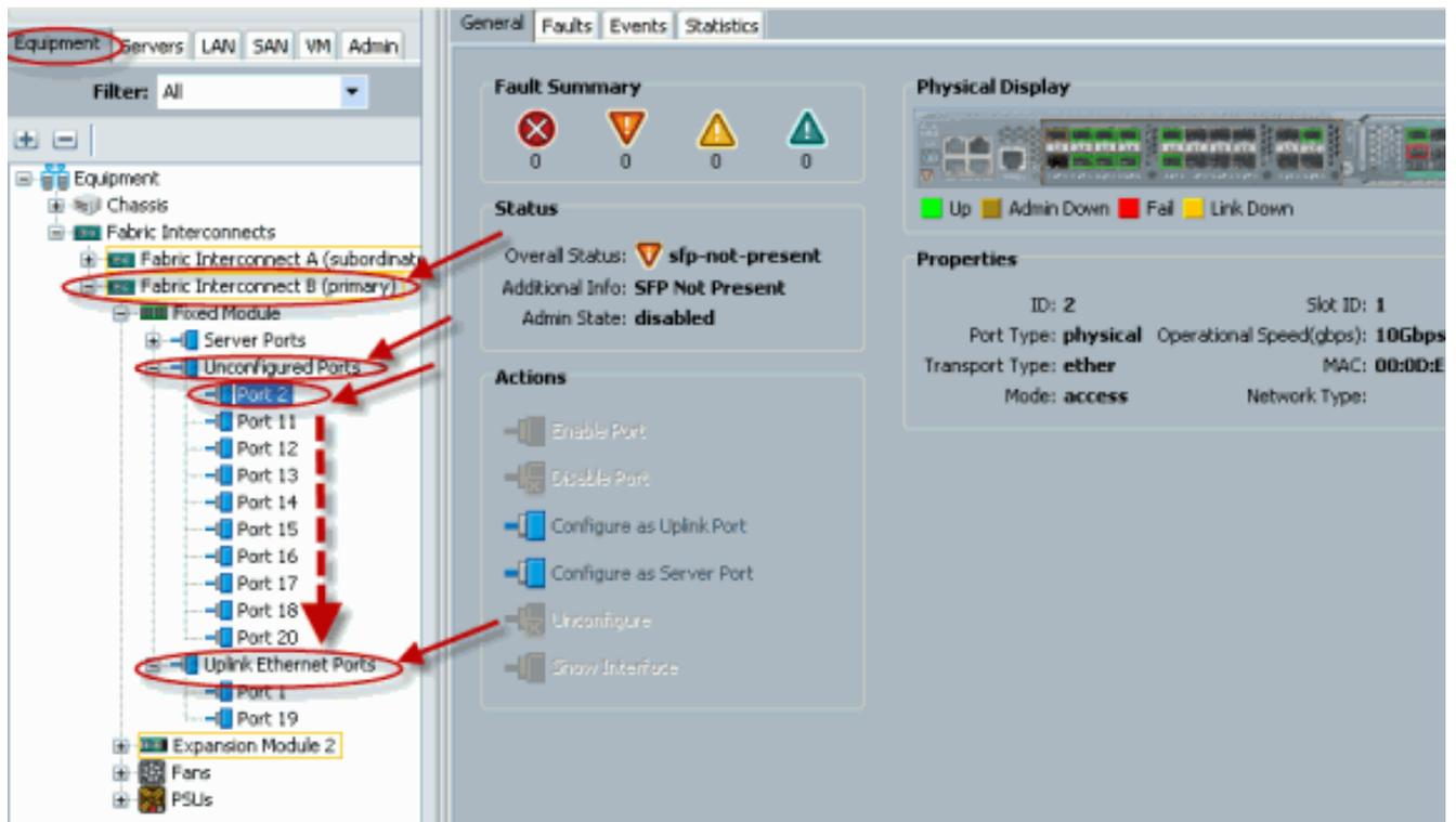
7. Como se muestra, un acceso de Ethernet del uplink se configura con éxito. Click OK.
