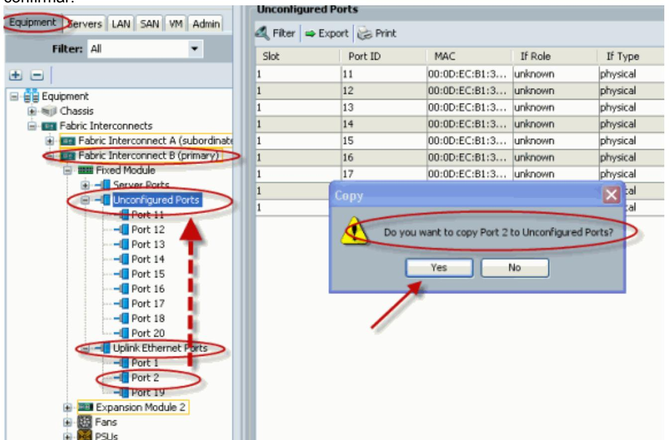
8. Como se muestra, usted tiene con éxito unconfigured un acceso de Ethernet del uplink.
