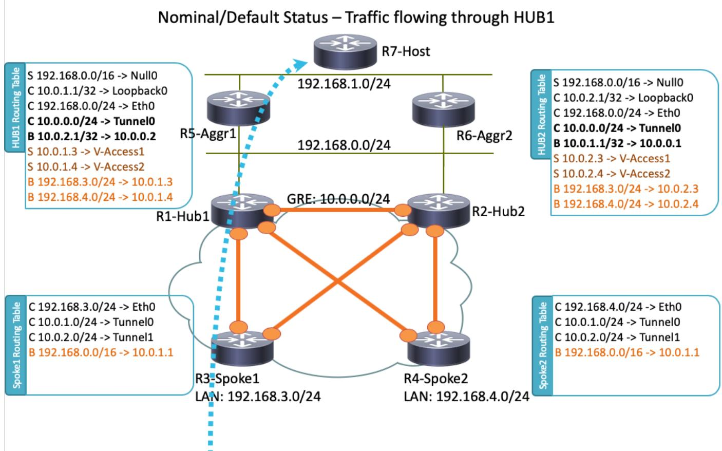
**Nota:** Todos los routers que se utilizan en esta topología ejecutan Cisco IOS versión 15.2(4)M1, y Internet Cloud utiliza un esquema de direcciones de 172.16.0.0/24.
