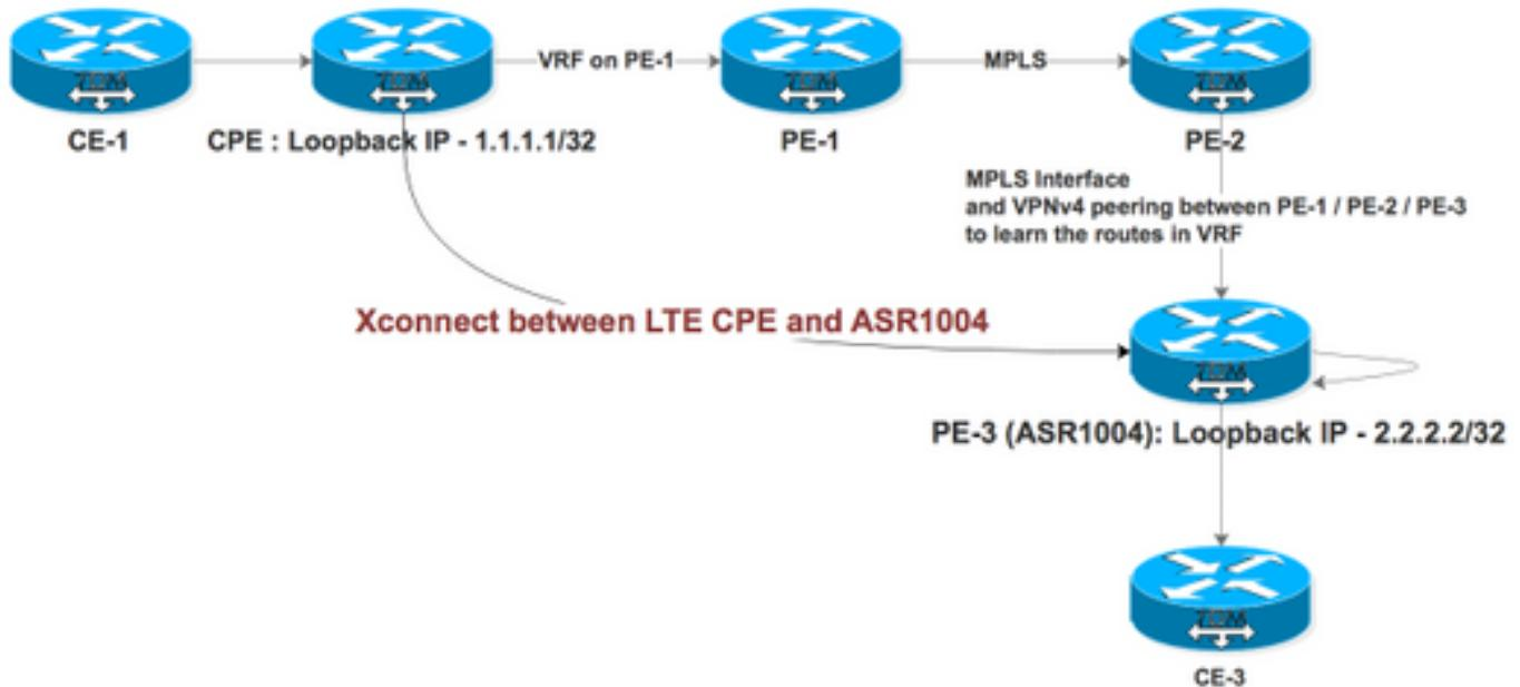
PE-1, PE-2 y PE-3 hacen de la red MPLS para ISP con PE-2 actuando como Reflector de Ruta (RR). CPE está conectado a PE-1 sobre VRF y ASR1004 está conectado a PE-2 con MPLS habilitado en la interfaz. ASR1004 también tiene VRF en el cual se supone que recibe las rutas VPNv4 de PE-1 a través de RR. El alcance del looback CPE desde ASR1004 se realiza a través de VRF sobre la interfaz MPLS.
