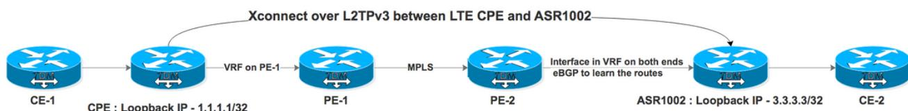
PE-1 y PE-2 hacen la red MPLS para ISP. CPE está conectado a PE-1 sobre VRF y ASR1002 está conectado a PE-2 sobre VRF. ASR1002 también tiene VRF en la interfaz conectada a PE-2. El alcance del loopback CPE desde ASR1002 se realiza a través de VRF sobre la interfaz IP.
