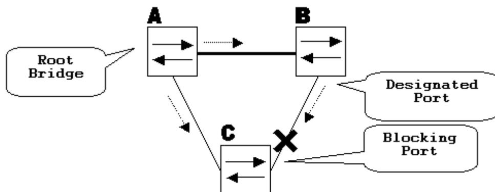
Durante el funcionamiento normal, el puente B es un puerto designado en el link B-C. El puente B envía las BPDU a C, que es el puerto de bloqueo. El puerto está bloqueado mientras que C detecta las BPDUs de B en ese link.
