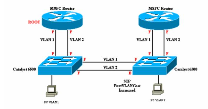
En este diagrama, la MSFC bloquea la conexión VLAN 2 al switch 2. La MSFC sólo bloquea las tramas L2 de salir de la conexión VLAN 2 al switch y no las tramas L3. Esto se debe a que la MSFC es un dispositivo L3 que puede determinar la diferencia entre una trama que necesita ser puenteada o ruteada. En este ejemplo, no hay segmentación de red y todo el tráfico de red fluye según lo deseado. Aunque no hay segmentación de red, todavía hay una única instancia de STP para todas las VLAN.
