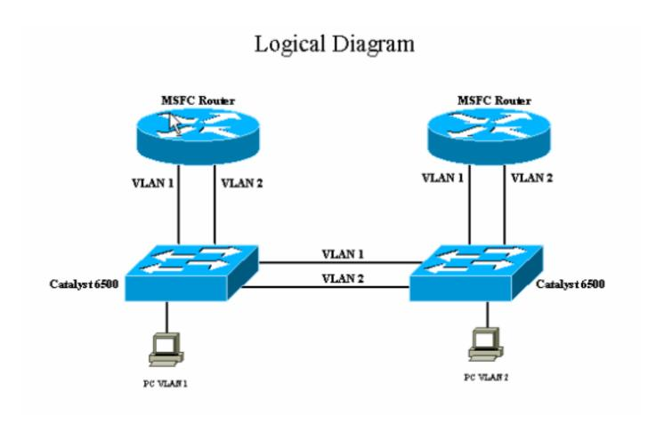
Una vez que las tarjetas de función de switch multicapa (MSFC) de ambos Catalyst 6500 se configuran para la conexión en puente con el STP IEEE, tanto la VLAN 1 como la VLAN 2 se unen para formar una única instancia de STP. Esta instancia única de STP contiene solamente una raíz STP. Otra forma de ver la red con el puente de la MSFC es considerar a las MSFC como puentes separados. Una instancia de STP que involucra a las MSFC puede resultar en una topología de red no deseada.
