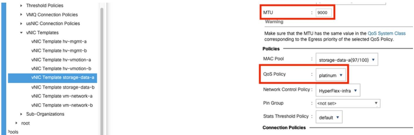
**Configuración de VLAN:** la VLAN de datos de almacenamiento de hx creada durante la implementación del clúster se debe permitir en la plantilla vnic. asegúrese de que no esté marcado como nativo
