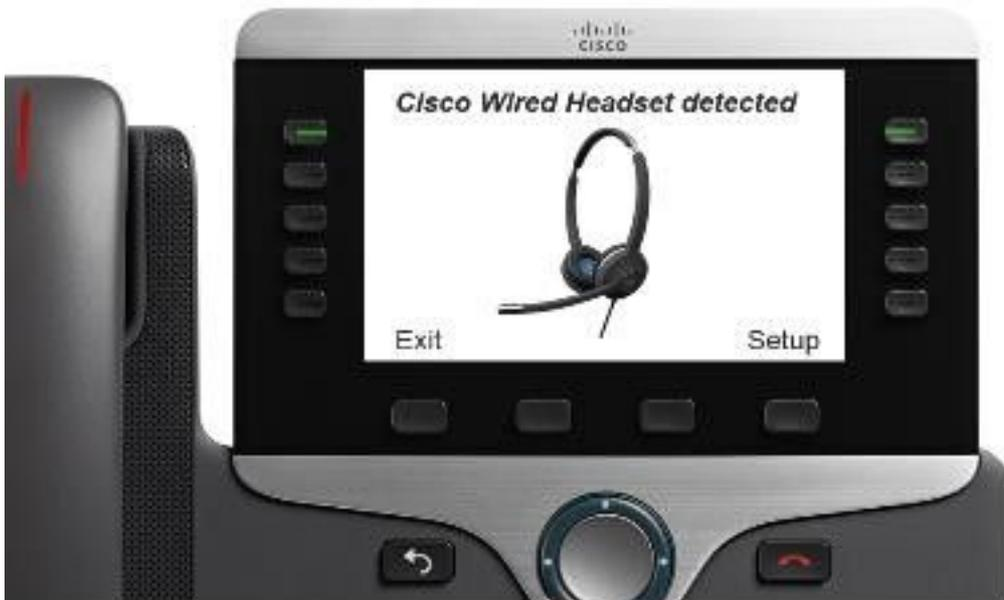
Paso 4. Para configurar la configuración de los auriculares, seleccione **Setup**. Puede tener acceso al menú como se muestra en la imagen.
