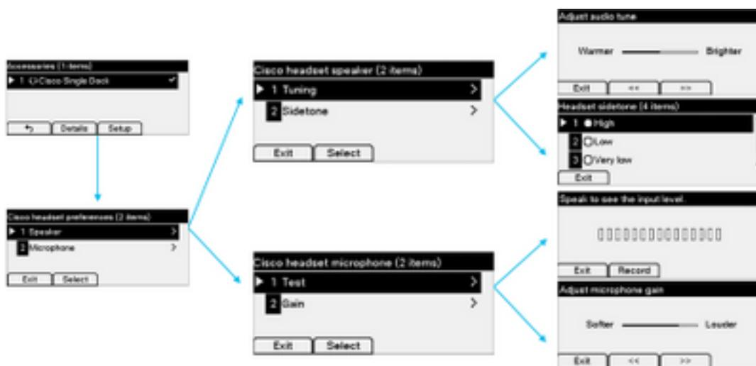
**Consejo:** Puede acceder al menú de configuración manualmente. Para las series 88XX y 78XX, navegue hasta **Settings > Accesorios > Setup**.
