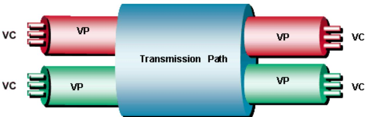
En el [diagrama](#) anterior, las celdas ATM que llegan al VC se conmutan según el número VPI y VCI en el encabezado de celda. Por otra parte, las celdas ATM que llegan al VP se conmutan según el número VPI solamente. La configuración del switch ATM determina si se supone que el switch es un switch VC o VP para un par VPI/VCI específico o VPI respectivamente.
