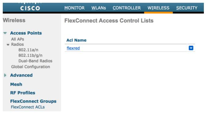
Erstellen einer FlexConnect-ACL mit dem Namen Flexred
