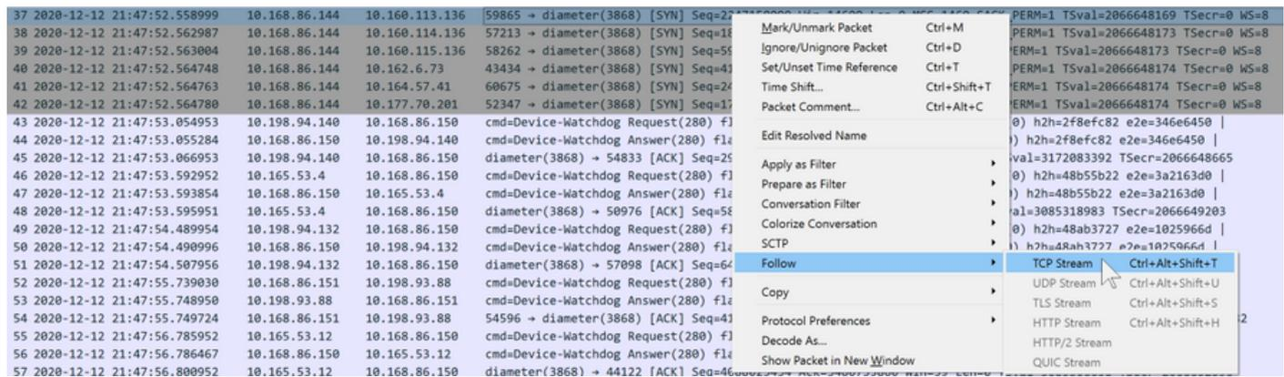
In diesem Szenario ist zu beachten, dass es KEINE weiteren Pakete außerhalb der SYN gibt. Dies bestätigt, dass die ASR wahrscheinlich ein SYN sendet, jedoch keine Antwort zurückruft. Dadurch wird verhindert, dass der ASR die Ursache für das nicht eingerichtete Verbindungsaufbau ist (obwohl dies nicht garantiert ist, wird das Paket möglicherweise nicht gesendet oder die Antwort verworfen, sodass ein externes PCAP bei der weiteren Verengung des Problems hilfreich wäre).
