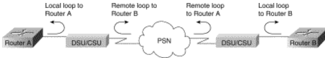
Abbildung 15-9: Lokale und Remote-Loopback-Tests von CSU/DSU
