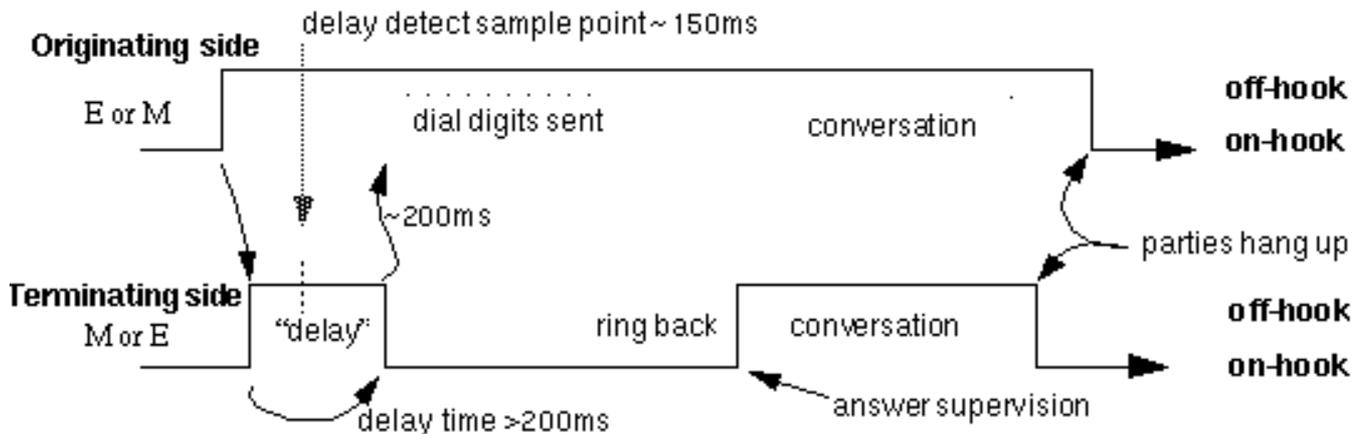
Bei Cisco 1750, 2600, 2800, 3600, 3800 und VG200 (mit einer E&M-VIC) beträgt die Standard-Wink-Verzögerung 200 ms. Weitere Informationen zur Überprüfung und Änderung der Signalisierungsparameter für die [Verzögerung](#) der [Wählverzögerung](#) finden Sie in der [Beispielausgabe "Verifizieren der Verzögerung bei der Anwahl"](#).
