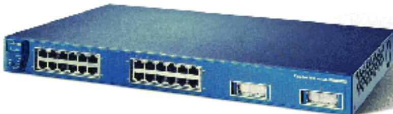
Der WS-C3524-PWR versorgt die Inline-Stromversorgung über die "verwendeten" Ethernet-Paare (Pins 1, 2, 3, 6).
