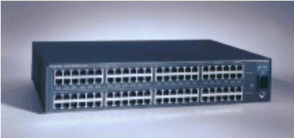
Das WS-PWR-PANEL versorgt das System mithilfe der "ungenutzten" Paare mit Strom (Pins 4, 5, 7, 8).
