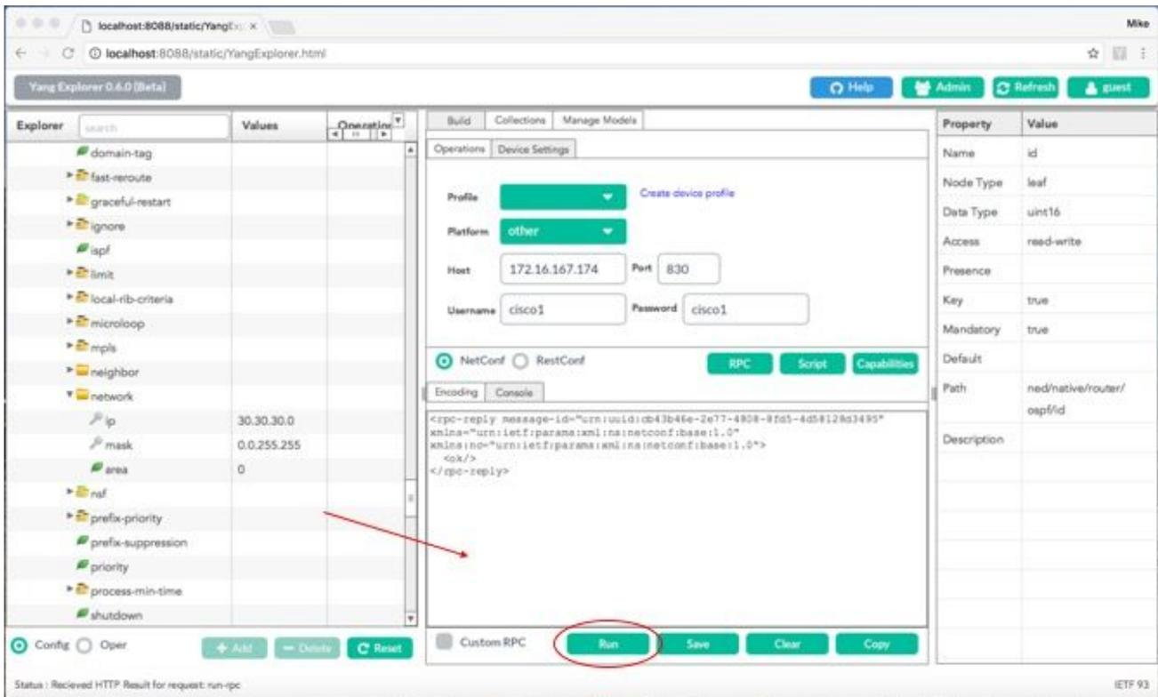
Dieser NETCONF/YANG-RPC-Vorgang zum Ändern der OSPF-Routing-Konfiguration über das Datenmodell "end.yang" spiegelt sich in der Catalyst 3850-Konfiguration wider, die über die CLI des Catalyst 3850 erfolgt. Eine Syslog-Meldung auf dem Catalyst 3850 gibt an, dass eine Konfigurationsänderung über NETCONF vorgenommen wurde.
