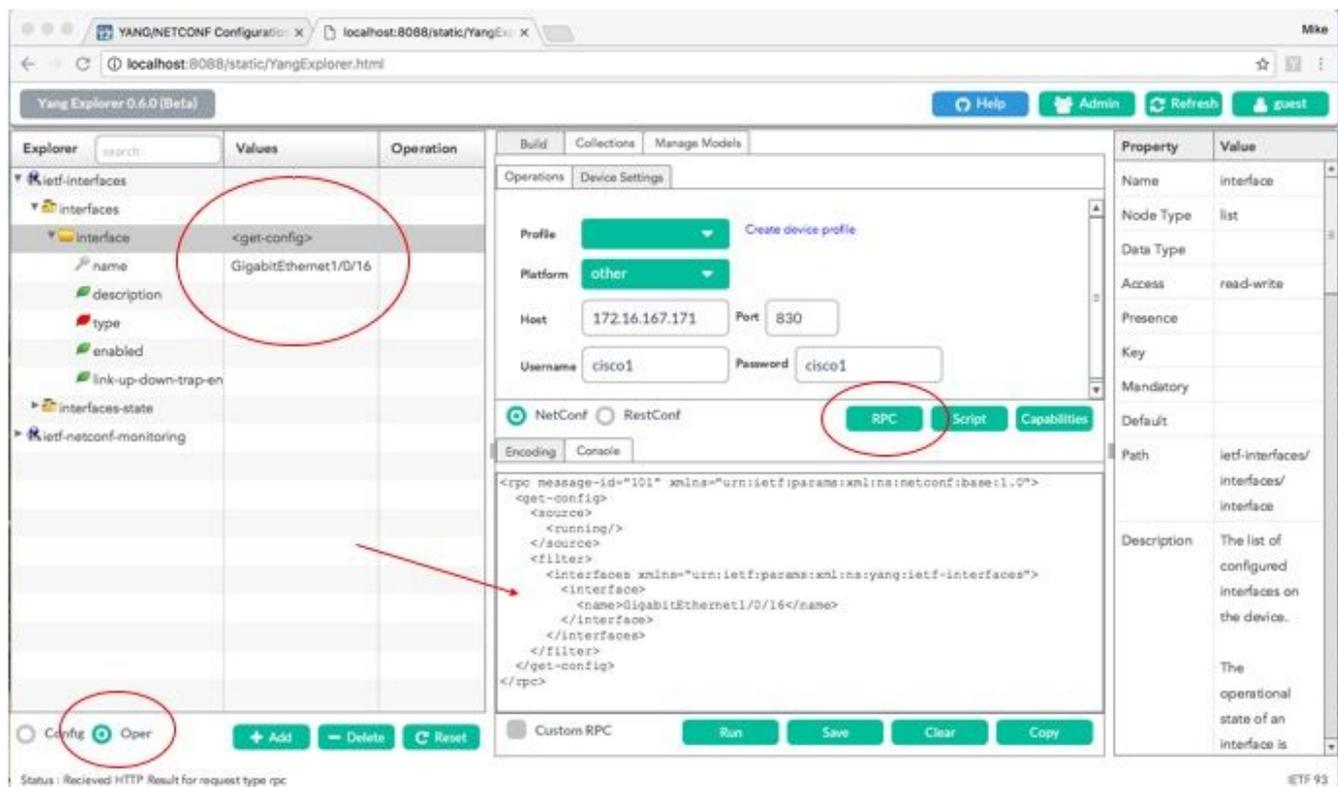
Run wird ausgewählt, um die RPC-Get-Config-Nachricht für GigabitEthernet1/0/16 über NETCONF an Catalyst 3850 zu senden. Der Catalyst 3850 antwortet mit der GigabitEthernet1/0/16-Schnittstellenkonfiguration, die "enabled" = true anzeigt.
