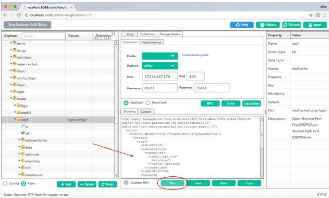
Im Folgenden wird eine Erweiterung der OSPF-Routing-Konfiguration dargestellt, die vom Catalyst 3850 als Antwort auf den RPC-Vorgang **get-config** zurückgegeben wird.
