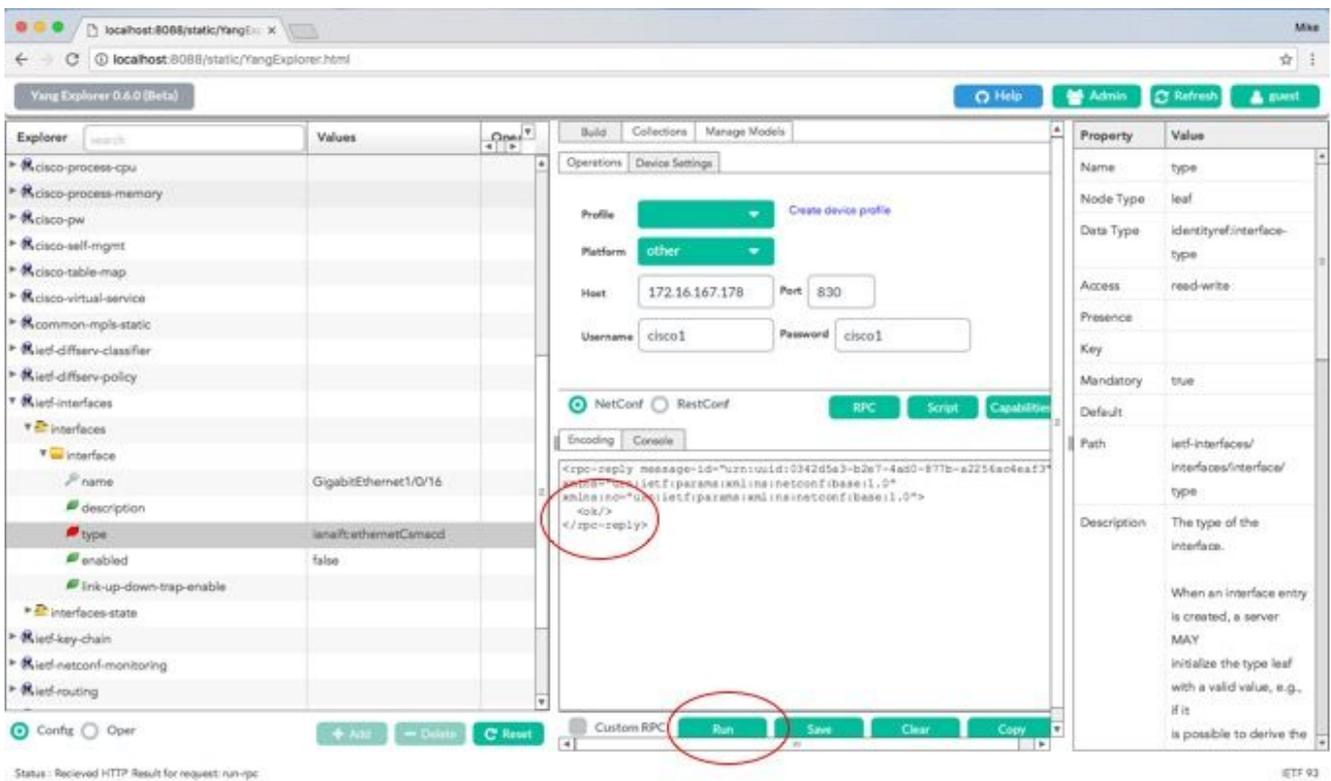
**Tipp:** Wenn Sie sich nicht sicher sind, wie das richtige Format für die Explorer-Werte aussehen kann, können Sie die vorhandene Konfiguration überprüfen, bevor Sie versuchen, die Parameter zu ändern. Dies kann mit dem **get-config**-Vorgang (Oper) wie dargestellt erfolgen.
