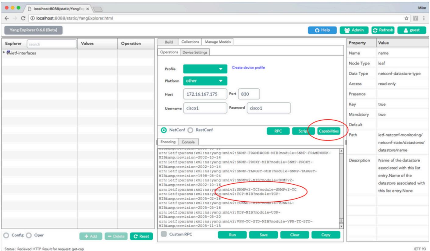
**Option 2:** Diese mit YANG formatierte NETCONF-RPC-Nachricht kann über NETCONF an den Catalyst 3850 gesendet werden, um die Funktionsliste abzurufen, die verfügbare smiv2-MIB-Modelle enthält.
