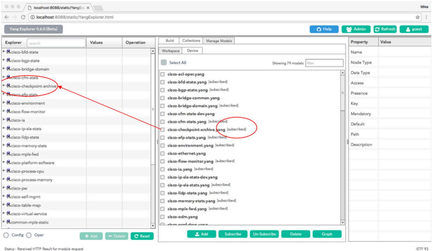
Andere Aufgaben können jetzt ausgeführt werden, z. B. das Erstellen des NETCONF/YANG-RPC, der zum Speichern der Konfiguration auf dem Catalyst 3850 erforderlich ist. Dies geschieht, wenn Sie die **RPC-Save-Conf** im Explorer-Abschnitt auf der linken Seite der Yang Explorer-Anwendung auswählen. Anschließend wird **RPC** ausgewählt, um den YANG-formatierten NETCONF RPC zu generieren, der über NETCONF an Catalyst 3850 gesendet werden kann, um die Konfiguration
