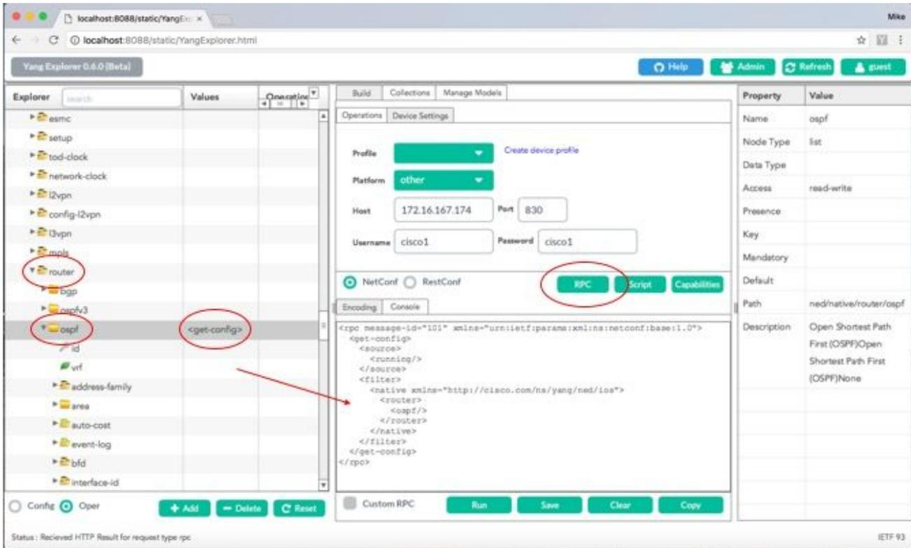
Als Nächstes wird **Run** ausgewählt, um die RPC-Nachricht über NETCONF an Catalyst 3850 zu senden. Der Catalyst 3850 antwortet mit seiner OSPF-Routing-Konfiguration.
