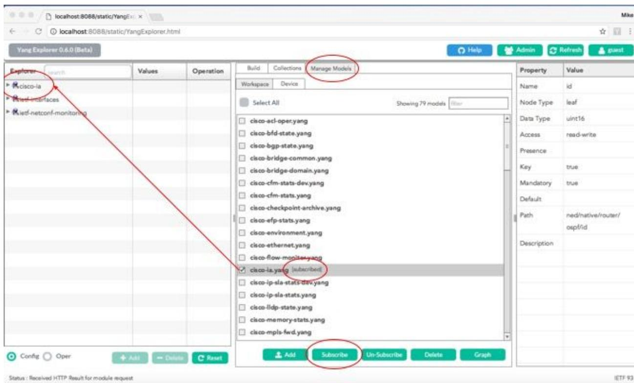
Sobald das **cisco-ia**-Datenmodell im Explorer-Abschnitt links von der YANG Explorer-Anwendungs-GUI erweitert wird, werden die verschiedenen Betriebsoptionen angezeigt. Als Beispiel für die Verwendung einer der verfügbaren Datenmodelloptionen cisco-ia.yang wird der Vorgang **save-config** ausgewählt, und der zugehörige **RPC** wird generiert, wenn Sie die RPC-Schaltfläche auswählen.
