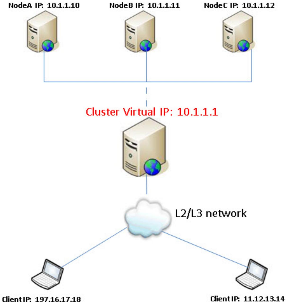
NLB VLAN 10 mit dem IP-Subnetz 10.1.1.0 /24 Die MAC-Adresse wird aus Gründen der Kürze gekürzt.
