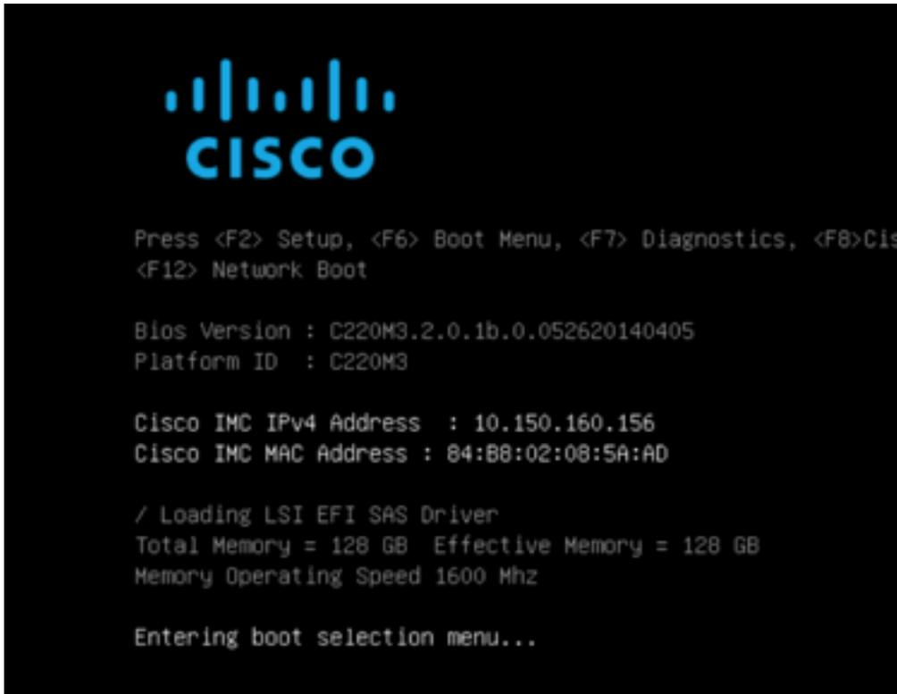
5.11 Wenn das Startmenü angezeigt wird, wählen Sie die Option Cisco vKVM-Mapped vDVD1.22 aus, und drücken Sie die Eingabetaste. Das System startet nun vom ISO-Installationsmedium aus.
