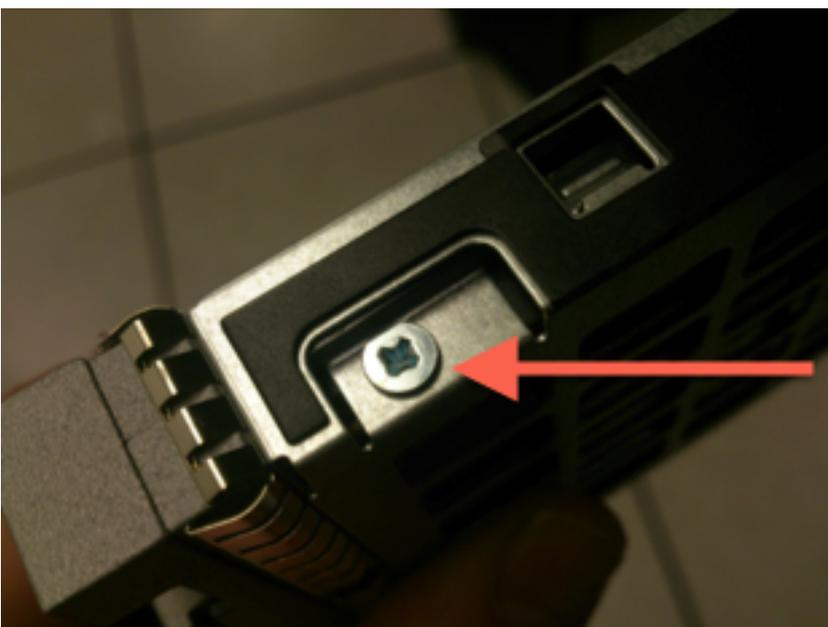
Abbildung: Vier Kreuzschlitzschrauben sichern das Laufwerk am Schlitten: zwei auf jeder Seite.
