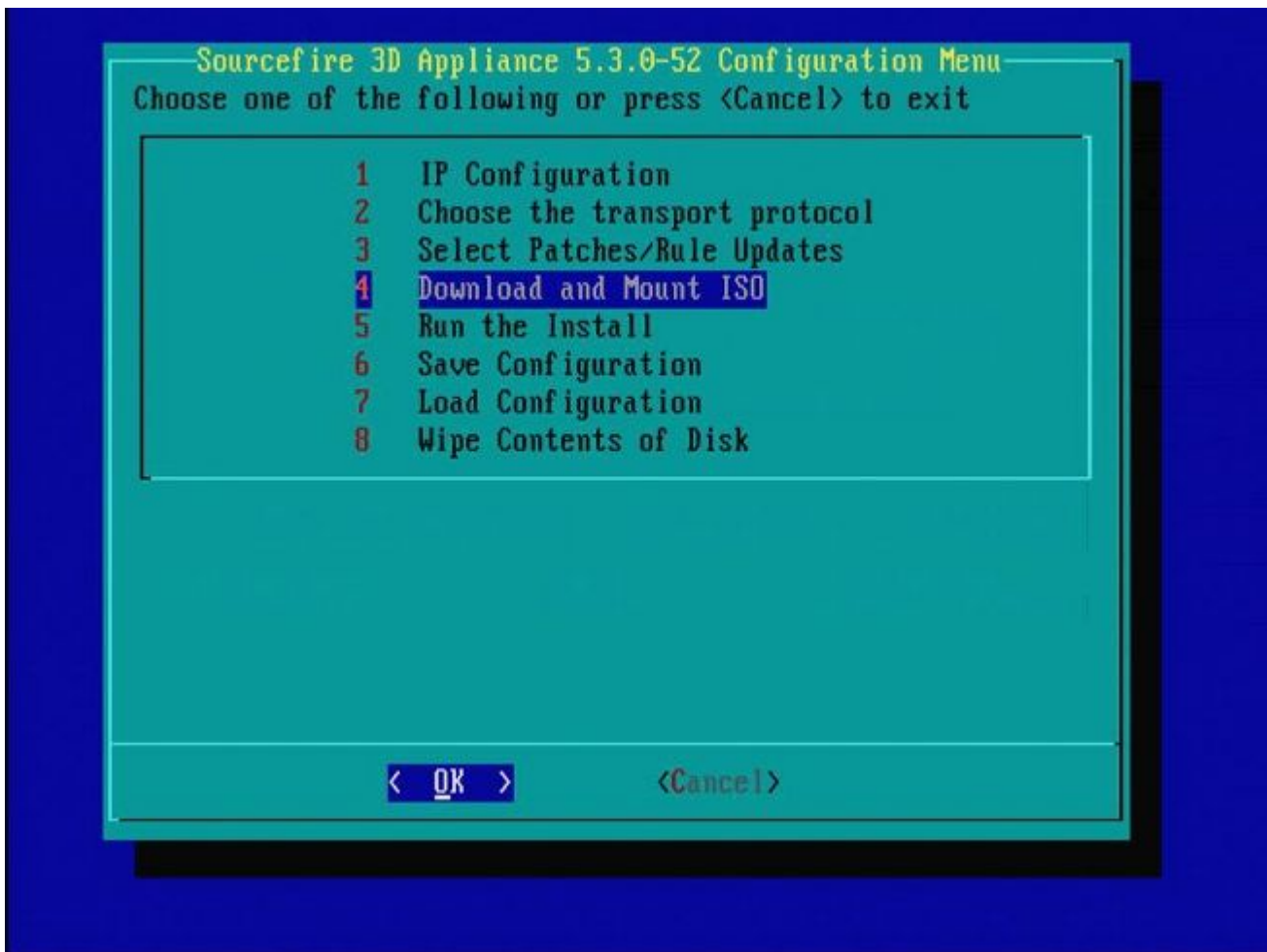
Abbildung 22: Der Cisco Support empfiehlt, Schritt 3 in diesem Prozess zu überspringen. Patches und Snort Rule Updates (SRUs) können nach Abschluss des neuen Images installiert werden.
