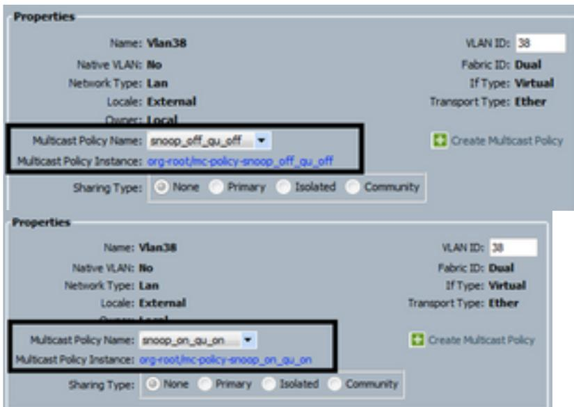
Wenn Sie mehrere VLAN-Objekte erstellen, die auf dieselbe VLAN-ID verweisen, wird sie bei Anwendung einer Multicast-Richtlinie auf **alle** VLAN-Objekte mit derselben VLAN-ID angewendet. Die neueste angewendete Multicast Policy wird auf alle angewendet. Beispiel: QMulticast wurde in Snoop\_off\_qu\_off (VLAN 38) geändert.
