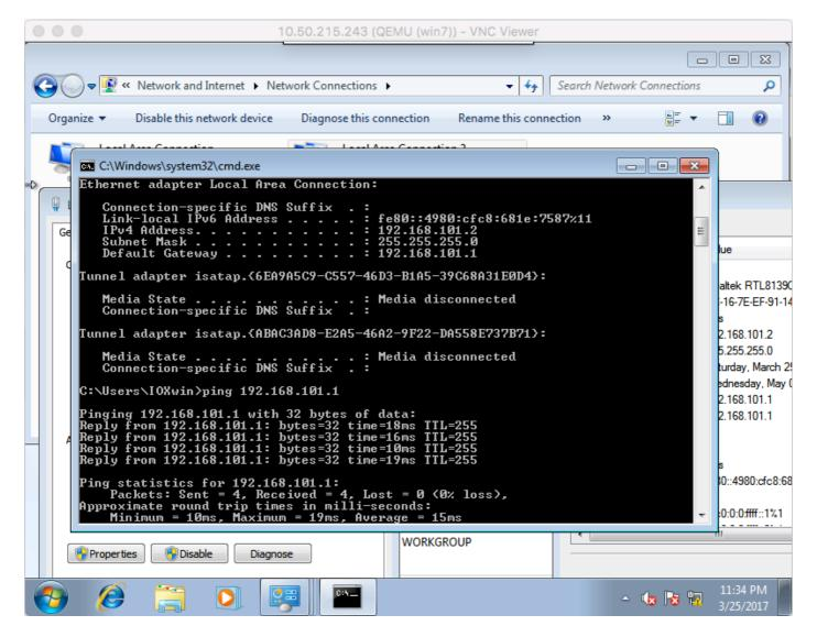
Wie Sie sehen können, haben diese Schnittstellen eine IP vom DHCP-Server erhalten, der unter Cisco IOS® ausgeführt wird und ohne weitere Konfiguration verwendet werden kann.
