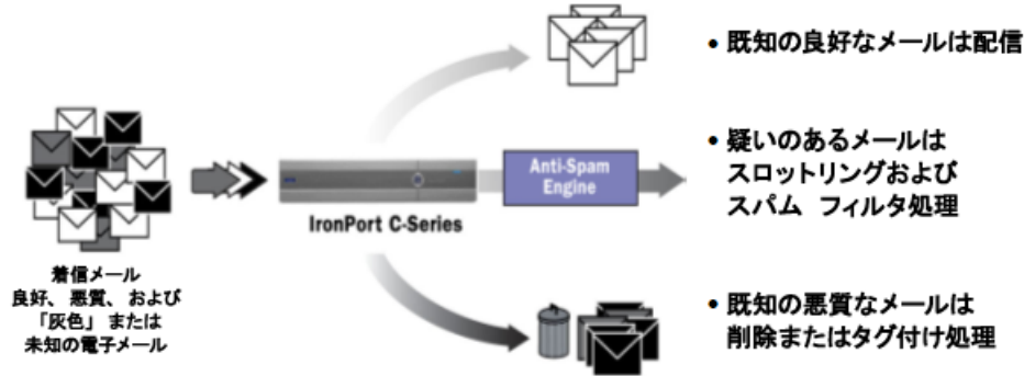
図 6-2 レピュテーション フィルタリングの例
