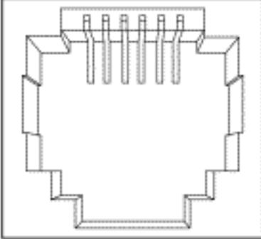
يستخدم منفذ الهاتف ل Cisco 575 LRE CPE موصل RJ-11. يوضح الرسم التخطيطي التالي نطاقات موصلات منفذ الهاتف. لاحظ أن السنون 1 و 2 و 5 و 6 على منفذ الحائط متصلة داخليا بالسنون المقابلة لمنفذ الهاتف. وهذا يسمح لزوج هاتف ثان وثالث بالمرور عبر CPE دون التأثير على اتصال LRE.
